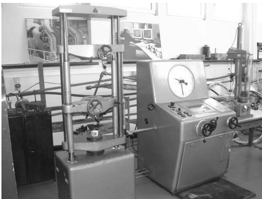
Rys. 3. Widok prasy hydraulicznej wykorzystanej do badań wytrzymałościowych próbek soli
