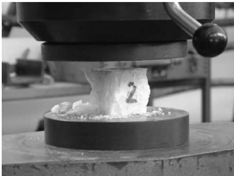
Rys. 4. Widok próbki soli szarej (Ukraina ) po próbie ściskania
