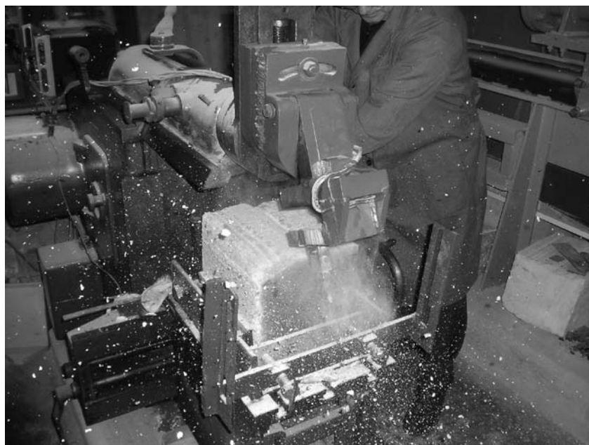
Rys. 2. Widok próbki soli różowej (KS Kłodawa) podczas przeprowadzania prób skrawania na jednej z wybranych płaszczyzn
