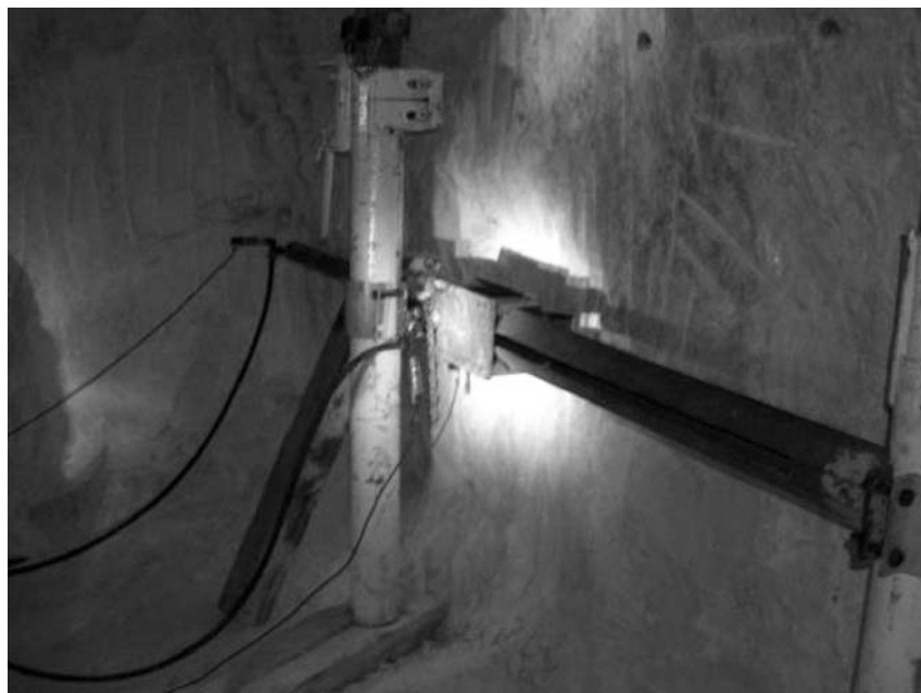
Rys. 1. Widok przyrządu do badania skrawalności na stanowisku nr 1 (sól różowa)
