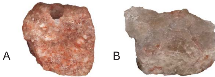
Rys. 1. A. Sól halitowo-karnalitowa (próbka nr. 228); B. Sól karnalitowo-halitowa (próbka nr 225), z solami tymi związane są maksymalne nagromadzenia gazu
