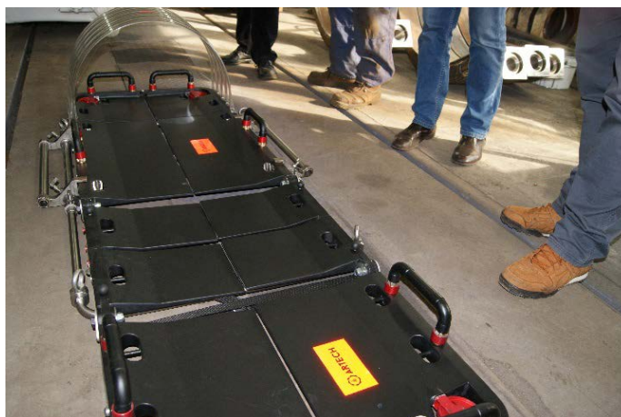
Rys. 2. Modułowe nosze monitorujące wraz z modulem ochronnym (Źródło: foto IMBiGS)
