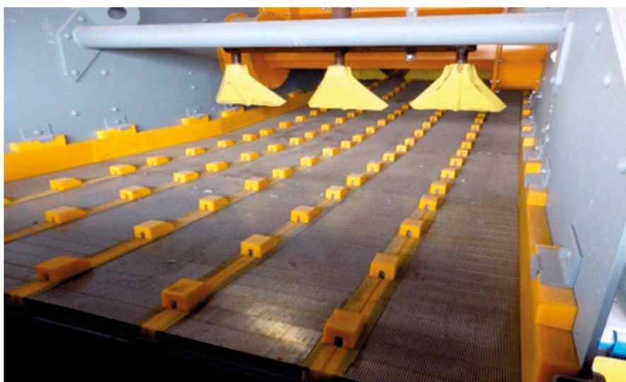
Rys. 3. Sita szczelinowe zgrzewane zabudowane w systemie PRO-CLIN na przesiewaczu PWP1-2Z-2,4×6,0
