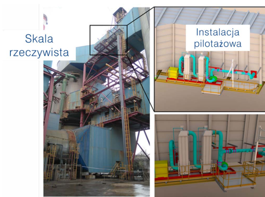
Rys. 2. Uproszczony schemat planowanej instalacji pilotażowej
