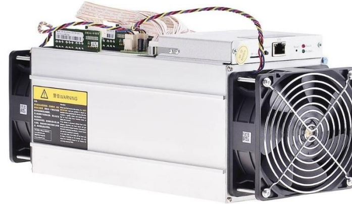
Rys. Koparka kryptowalut typu ASIC – Antminer S9
