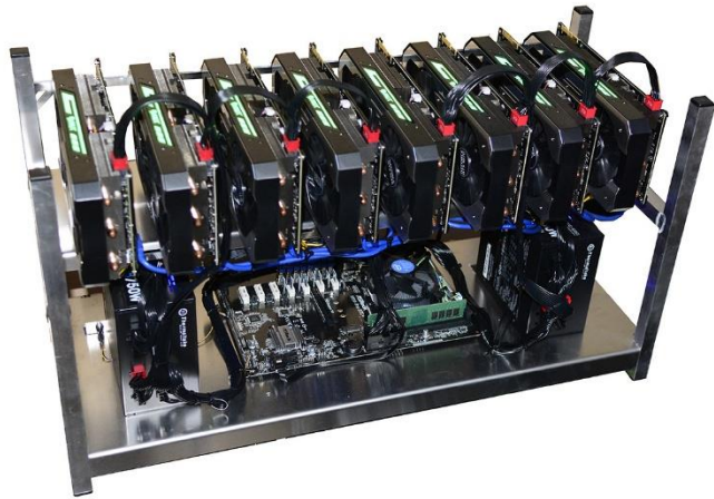
Rys. Koparka kryptowalut złożona z 8 kart graficznych
