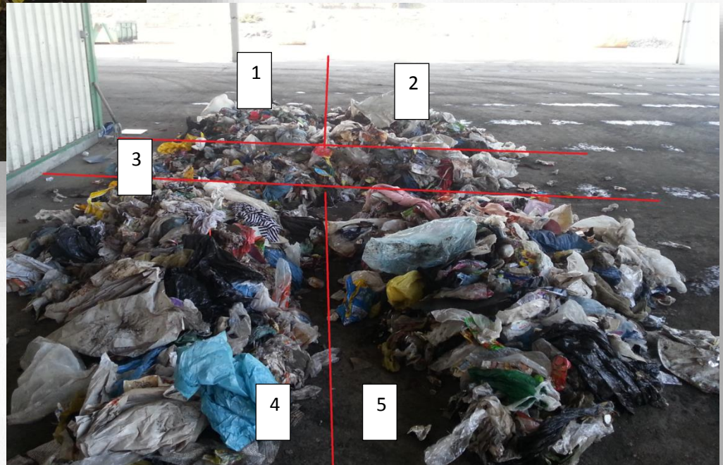
Rys. 4. Belka odpadów podzielona metodą kopertową
