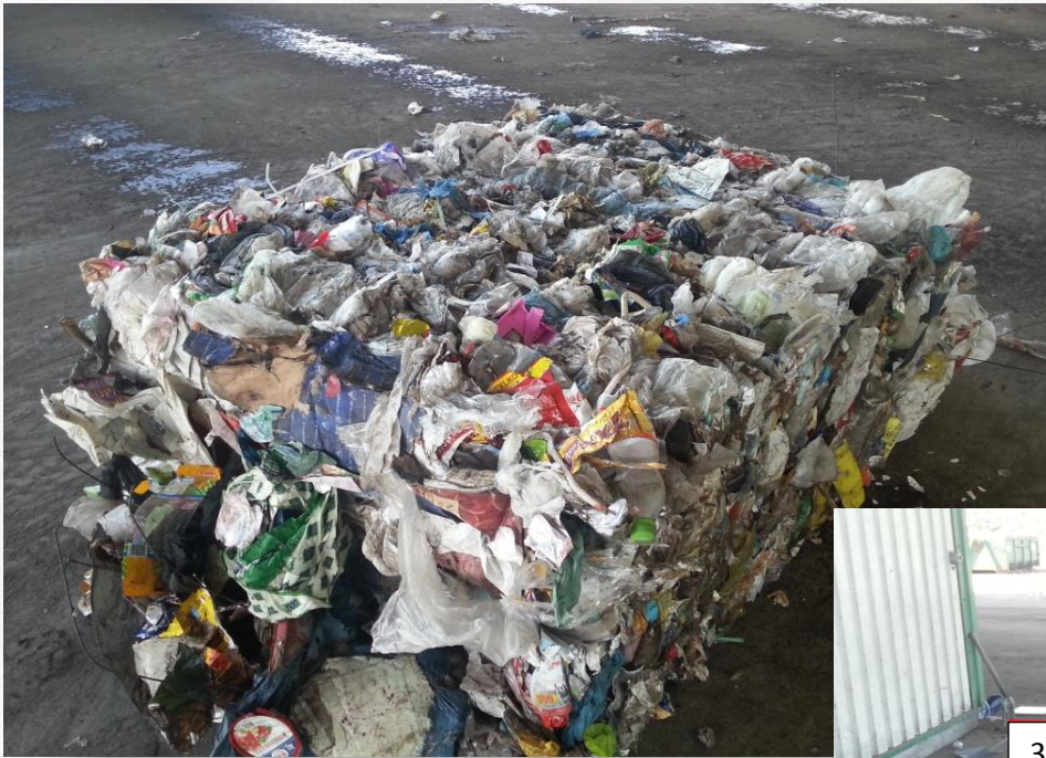
Rys. 3. Zbelowane odpady frakcji nadsitowej
