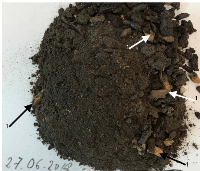
Rys. 1. Niespalone fragmenty biomasy (1) w jednej z badanych próbek popiołu uzyskanych ze spalania pelletu drzewnego, obraz makroskopowy
