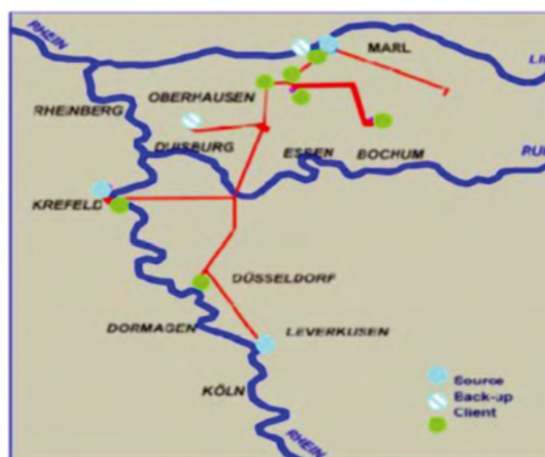
Rys. 2. System gazociągów wodorowych w Zagłębiu Rury
