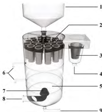
Rys. 3. Schemat sorpcyjnej kolumny ciśnieniowej (SNK)
